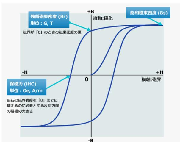
Figure 1: 强磁性材料的磁化曲线。
