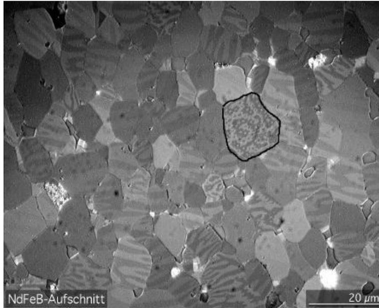
Figure 4: 在Kerr显微镜下观察到的NdFeB晶体中的磁畴，图片来自维基百科。
